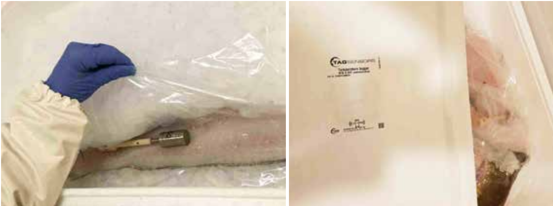
Figur 4. Temperaturlogging med tradisjonelle loggere (til venstre) og Tag-sensor festet til undersiden (her snudd opp ned) av isoporkasse med iset torsk.
