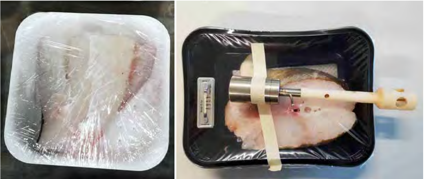
Figur 2. Torsk lagret i luft (til venstre) ble sammenliknet med torsk pakket i modifisert atmosfære (til høyre). Keep-it indikator ble festet til pakningen med modifisert atmosfære og temperatur er kontrollert med referanse temperaturmålere.
